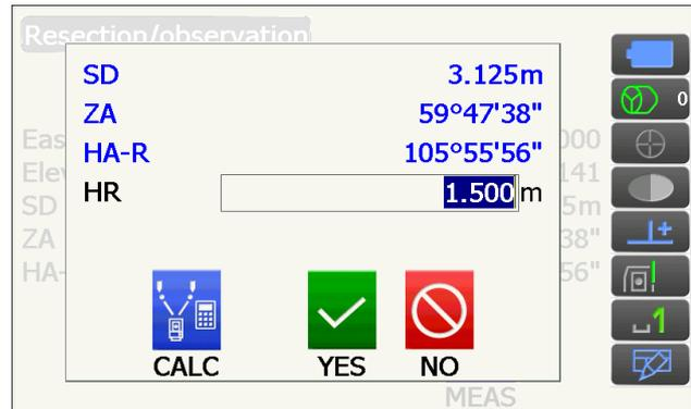
6. Pulse **[CALC]** (calcular) o **[YES]** (sí) para iniciar automáticamente los cálculos una vez completadas las observaciones de todos los puntos conocidos.
