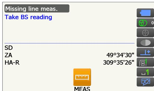
3. Haga puntería en el blanco y pulse **[MLM]** (medición entre puntos) para iniciar la observación.
