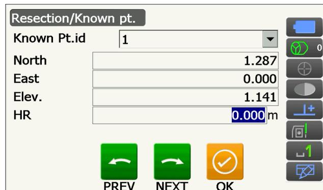
4. Haga puntería en el primer punto conocido y pulse **[MEAS]** (medir) para iniciar la medición. Los resultados de la medición se mostrarán en la pantalla.
