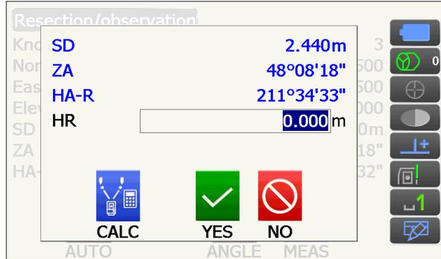
Para el tercer punto en adelante, aparecerá **[AUTO]** (automático). Si pulsa **[AUTO]** (automático), el instrumento rotará hasta el siguiente punto y comenzará la medición automática.
