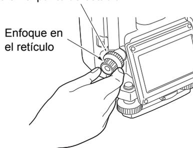
4. Ajuste los tornillos niveladores para centrar el punto de estación en el retículo de la plomada óptica.
