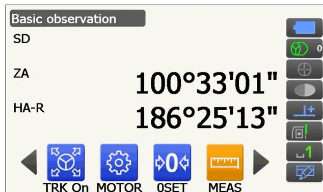
Introduzca los ángulos vertical y horizontal en la pantalla «Motor».
