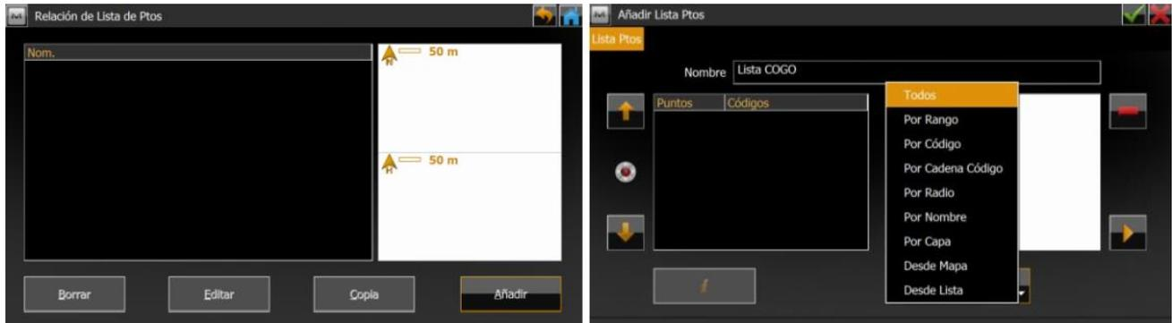
Para el ejemplo, se seleccionan 5 puntos desde la lista. Luego presione el visto bueno verde en el costado superior derecho.
