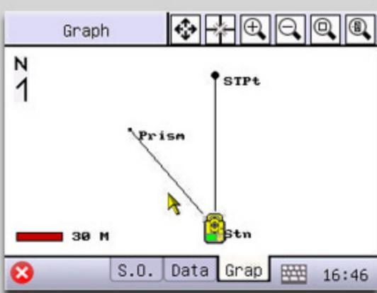
Al levantar o replantear, el software integrado nos permite cambiar de modo a Gráficos para ver la estación y los puntos radiados/levantados en cualquier momento. Permite hacer zoom, posicionar estación y ver el mapa completo.
