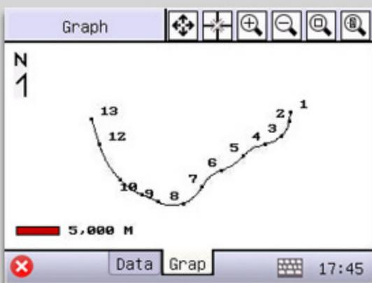
“Road Design” es una función que nos permite ingresar o importar los datos de alineación horizontal y vertical a la estación.
