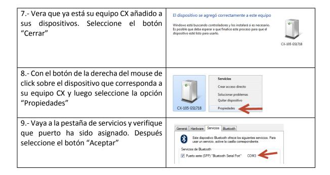
Hasta aquí ya está configurada la estación e identificada en su computadora para iniciar con la transferencia de datos.
